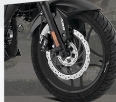
• **SISTEMA DE FRENOS ANTIBLOQUEO DE UN SOLO CANAL**
